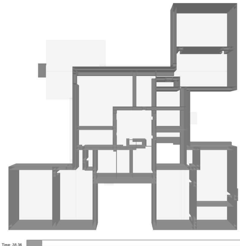
Рисунок 10. Этаж 2. Распространение дыма через 38,6 с после начала пожара.
