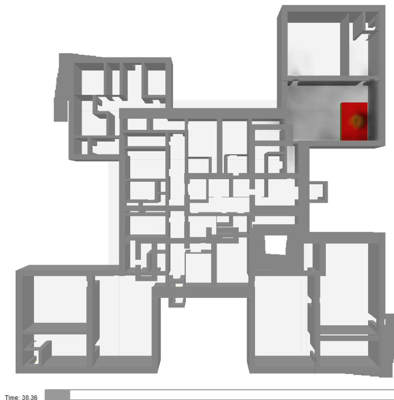
Рисунок 4. Этаж 1. Распространение дыма через 38,6 с после начала пожара.
