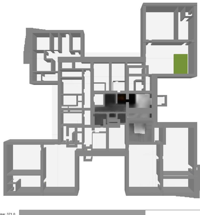
Рисунок 43. Этаж 1. Распространение дыма через 371 с после начала пожара.
