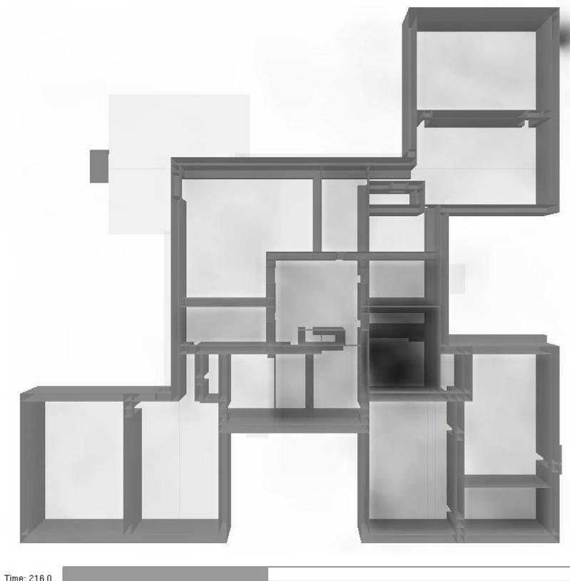
Рисунок 22. Этаж 2. Распространение дыма через 215,8 с после начала пожара.
