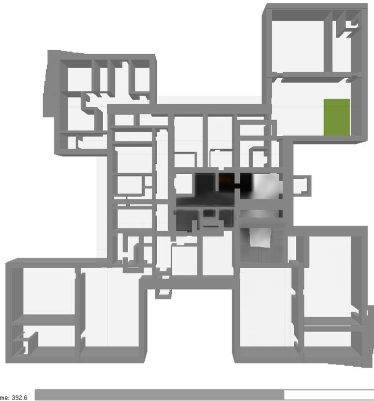
Рисунок 45. Этаж 1. Распространение дыма через 392,8 с после начала пожара.
